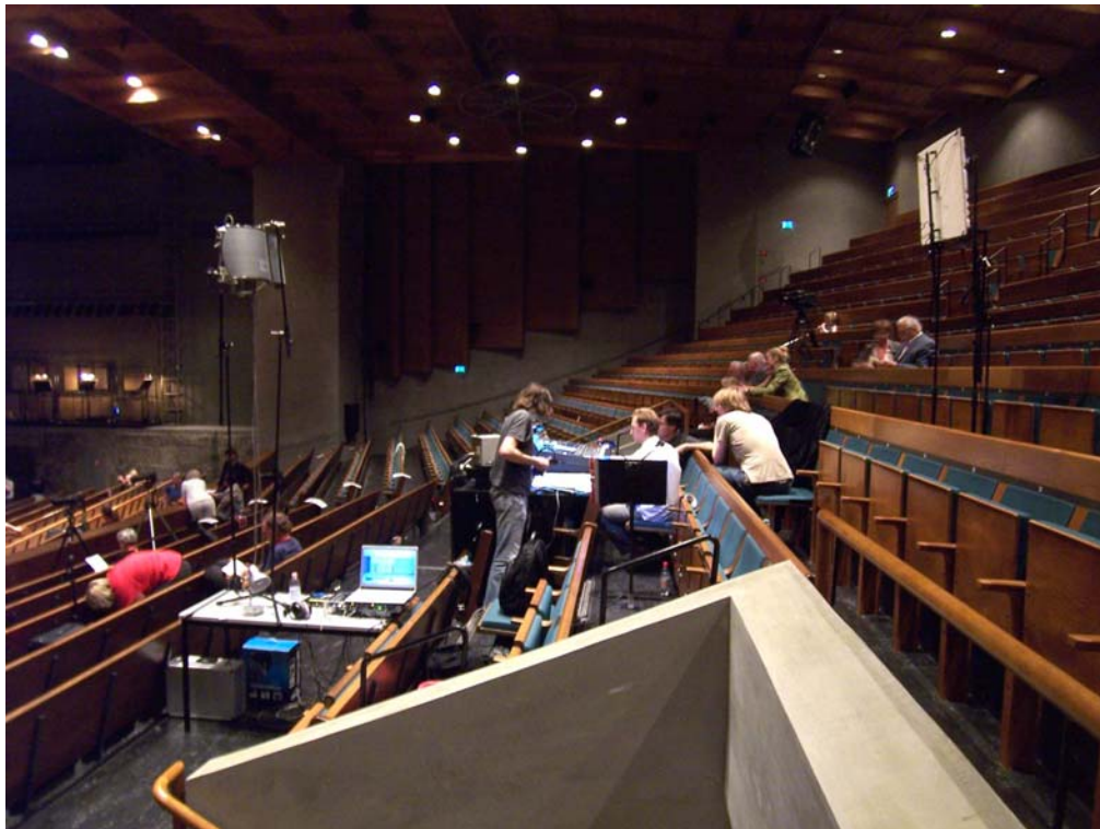
Abb. 5.3: BPT-3 Mikrofon mit halbkreisförmigem Absorberpanel (Front-System) und Blumlein-Paar mit flachem Absorberpanel (Rear-System) auf der Zuschauertribüne der Felsenreitschule
