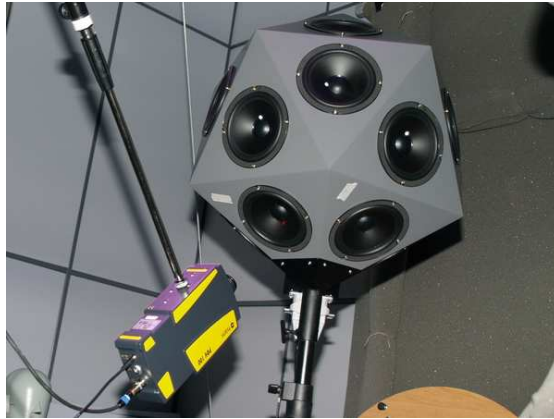
Abbildung 1: Icosaeder mit justiertem Laservibrometer
