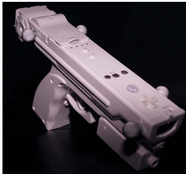
Abbildung 2: Zeigegerät: Fernbedienung mit Pistolenaufsatz und Reflektoren
