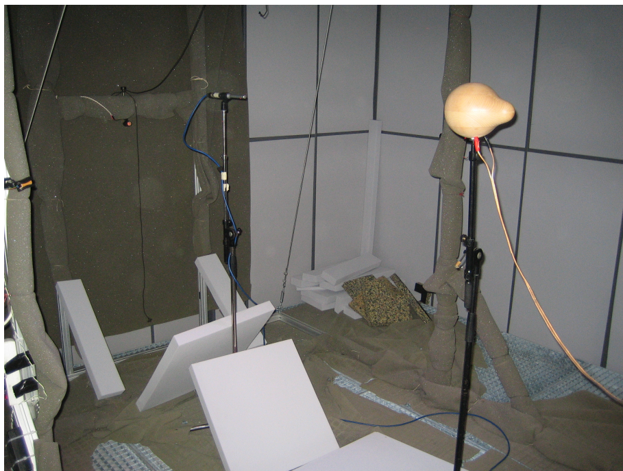
Abbildung 3.6: Vermessung der Mikrofonfrequenzgänge in der Messkoje des IEM
