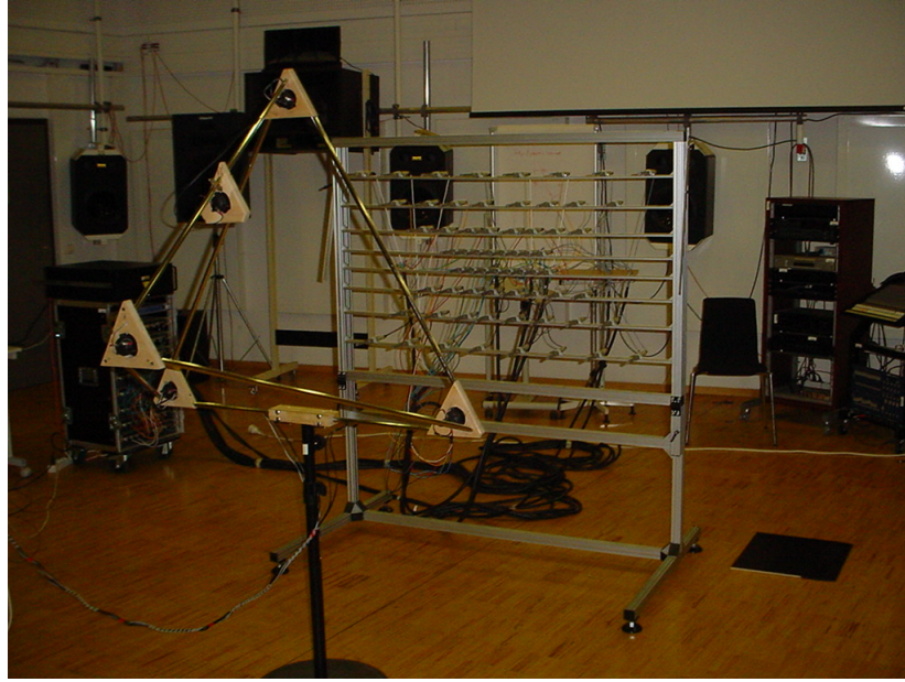
Abbildung 4.1: Aufbau der Messeinrichtung im Cube: im Vordergrund die tetraederförmige Lautsprecheranordnung, im Hintergrund das Mikrofonarray
