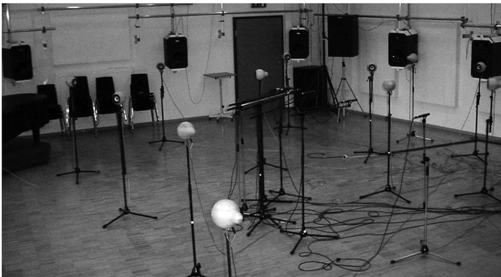
**Abb. 7.4.:** Array3 - chaotisches Array: Beliebige Verteilung von 15 Lautsprechern. Der Fokuspunkt befindet sich an der Position des am weitesten links stehenden Mikrophones - genauer an dessen Membran.
