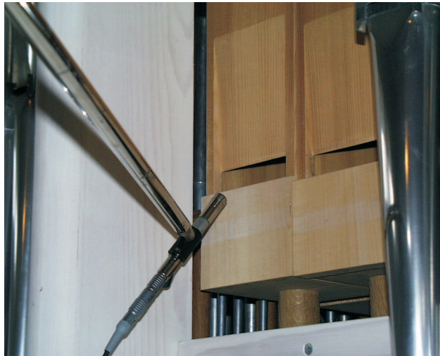
Abbildung 3.3: Mikrofonanordnung der Nahmessung
