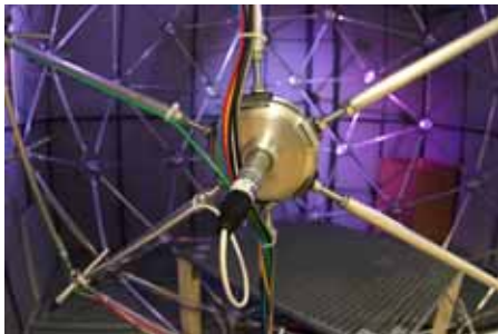
(a) Verkabelung der Mikrofone entlang der Alustangen
