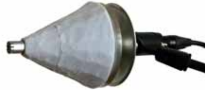
(b) Messmikrofon mit Kegelabsorber
