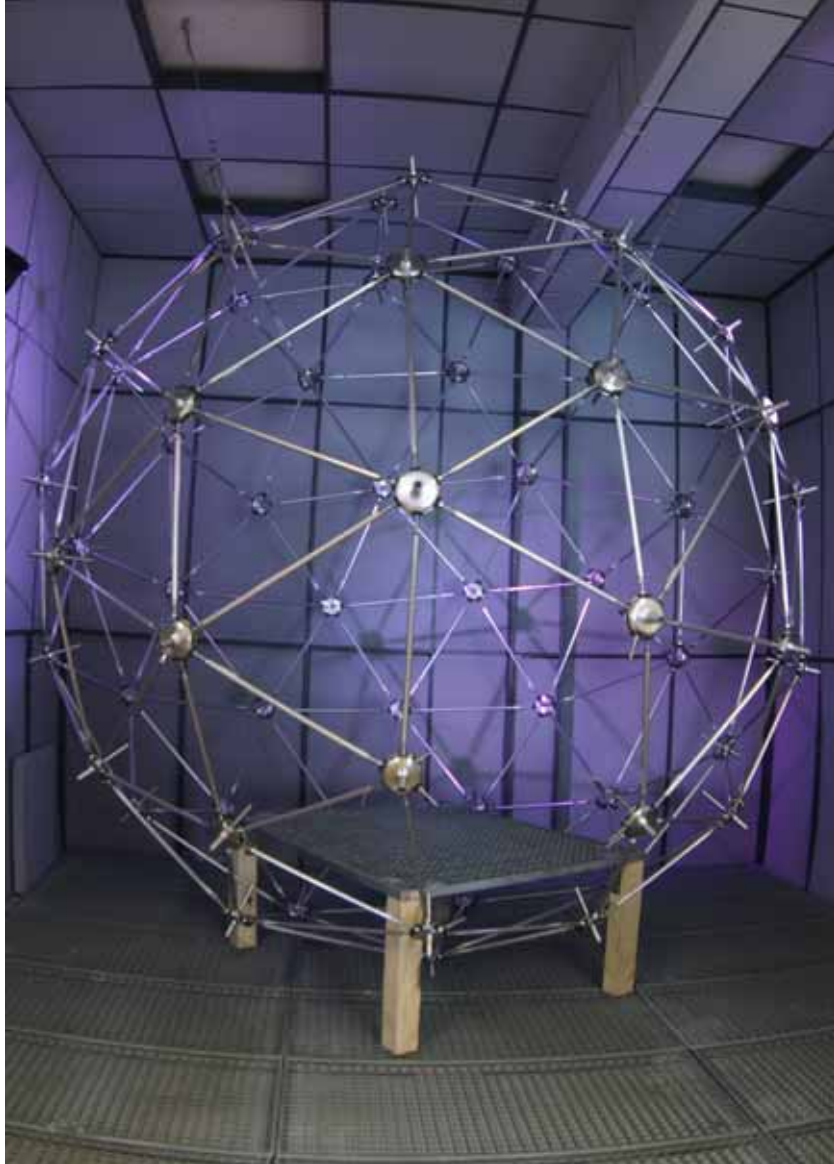
Abbildung 3.3.: Mikrofonkugel im Messraum ohne Verkabelung
