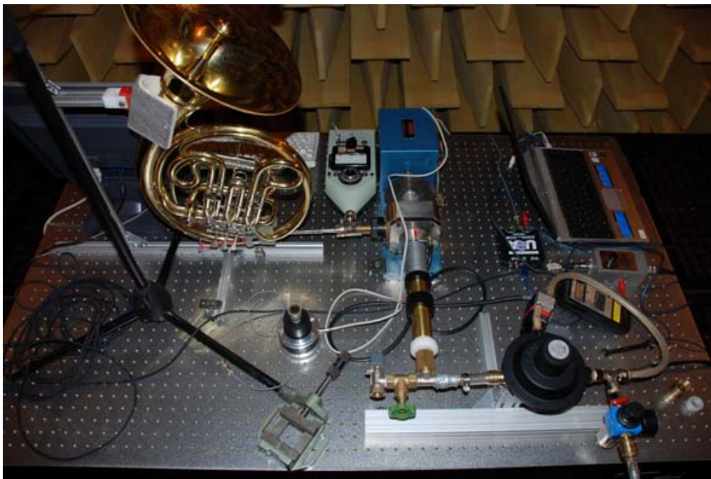
Aufbau Messung Übertragungsfunktion Sirene
