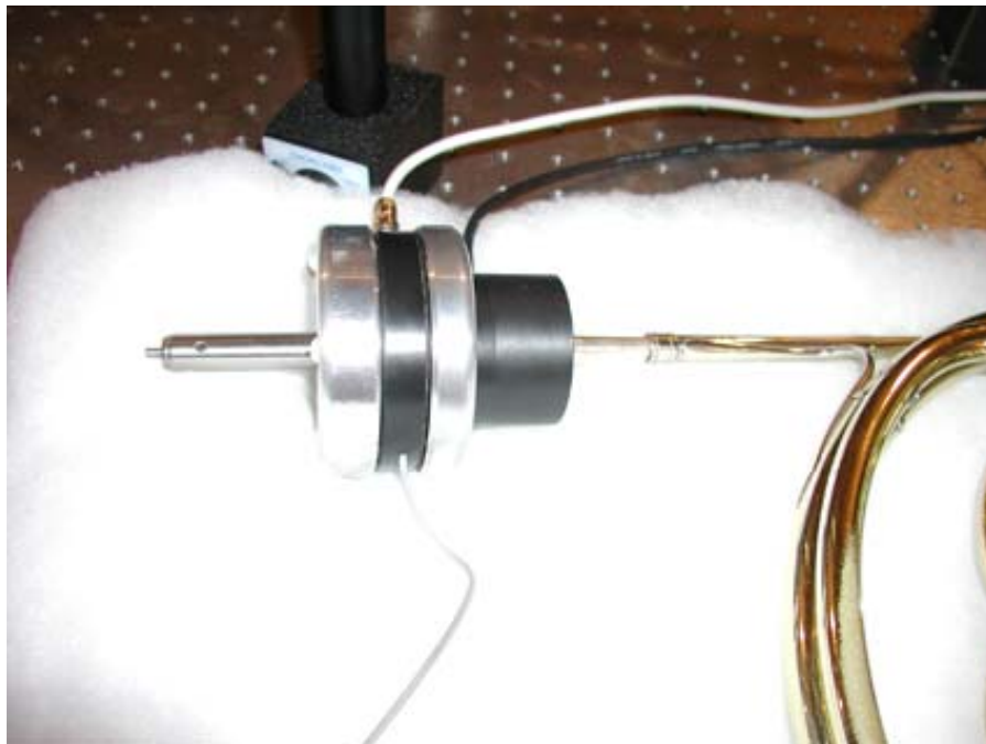
Abbildung 71 : Messkopf mit integriertem Messmikrofon
