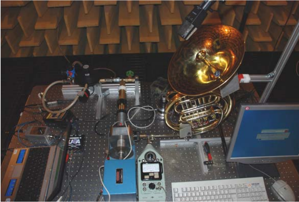
Aufbau Messung Übertragungsfunktion Sirene
