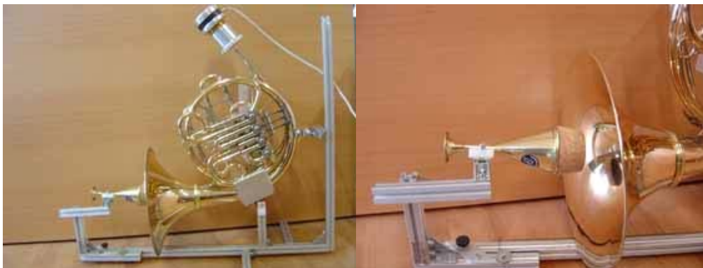
Abbildung 77 : Messaufbau Horn gestopft bis offen
