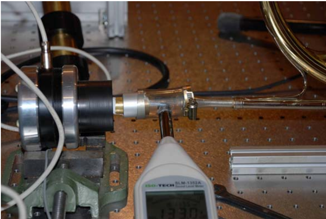
Aufbau Messung Übertragungsfunktion mit BIAS Messkopf und externem Mikrofon
