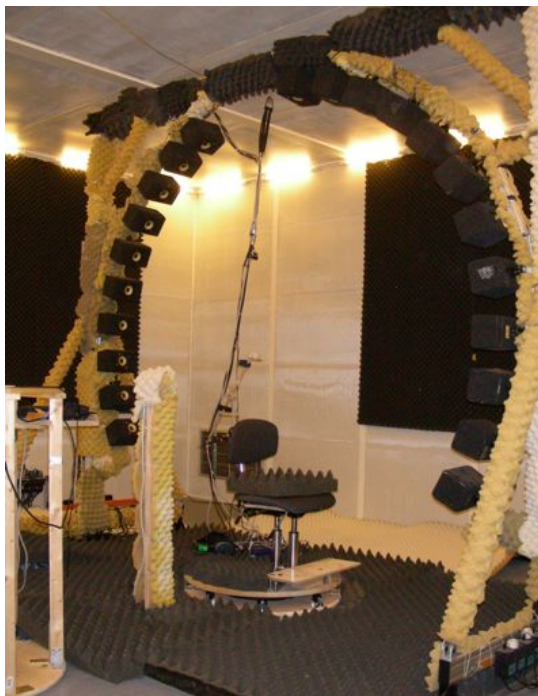
(a) HRTF-Messplatz des ISF Wien mit Lautsprecher-Array
