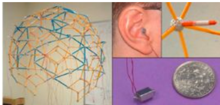
Abbildung 5: links: Mikrofonarray, unten: Microspeaker, oben Mitte: Microspeaker eingebaut, oben rechts: Messmikrofon [ZDGG06]
