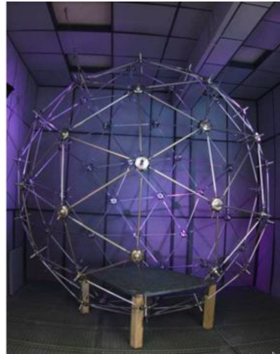
(b) 64-Kanal-Kugelmikrofonarray des IEM
