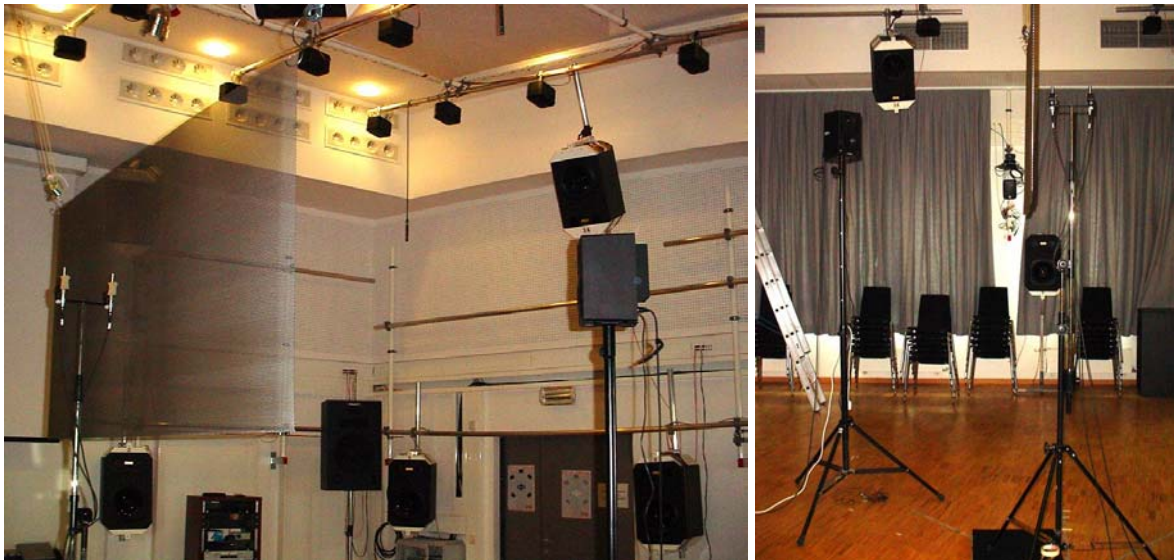
Abb. 6.17: Streckmetall 10 x 4,5 mm unter 45° Einfallswinkel mit Lautsprecher Yamaha MSP 5
