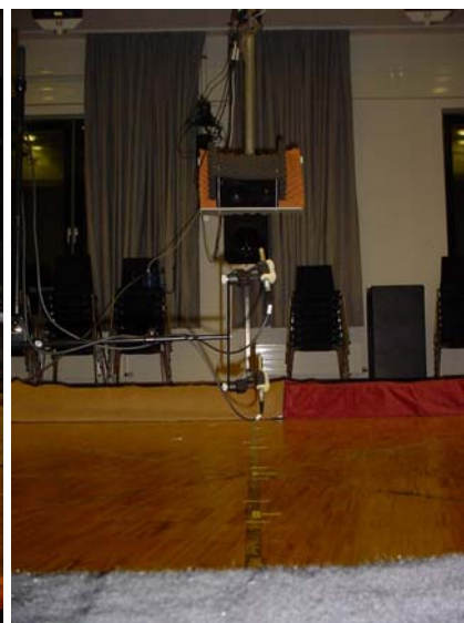
Abb. 6.8: Messung des schallharten Bodens bei 45° Einfallswinkel
