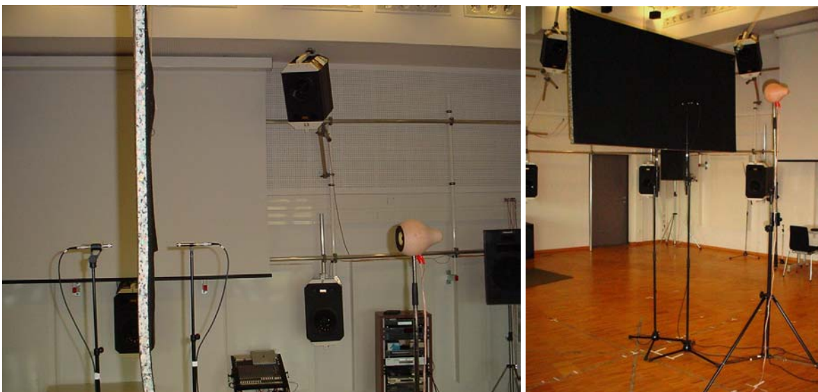
Abb. 6.19: Schaumstoff 40 mm, 0° Einfallswinkel mit tropfenförmigem Lautsprecher
