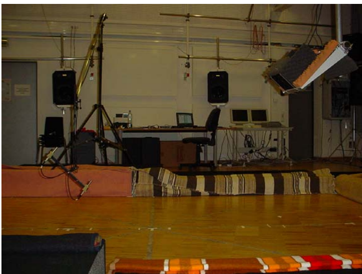
Abb. 6.8: Messung des schallharten Bodens bei 45° Einfallswinkel
