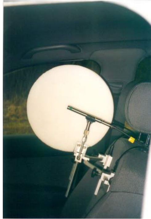
Abb. 11.a und Abb. 11.b Mikrofonaufbau zur Aufnahme in Binauraltechnik (mit Trennscheibe)
