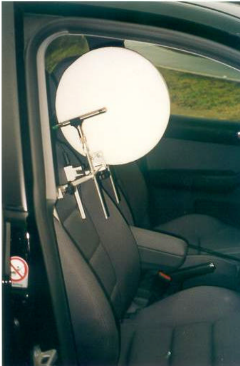
Abb. 11.a und Abb. 11.b Mikrofonaufbau zur Aufnahme in Binauraltechnik (mit Trennscheibe)
