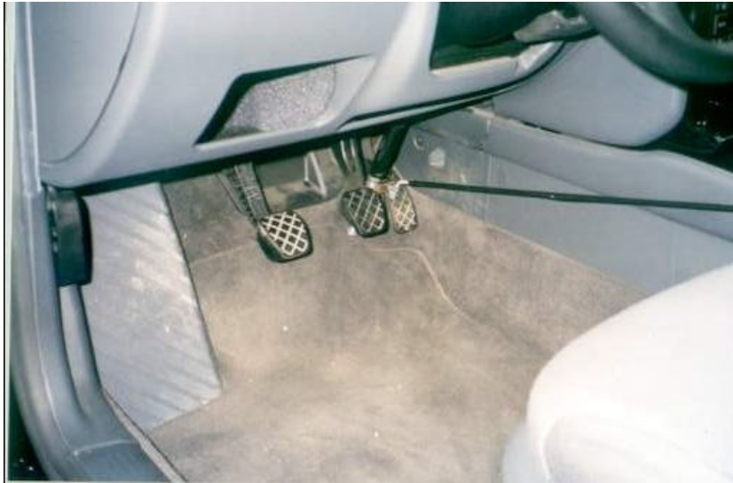
Abb. 9. Mechanische Gaspedalfixierung bei Audi A3
