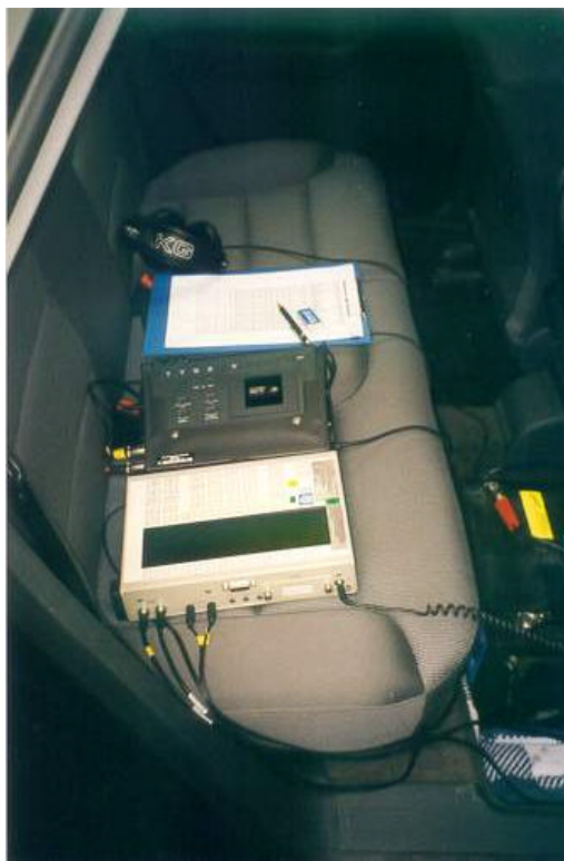
Abb. 14. Messgeräteaufbau auf dem Rücksitz
