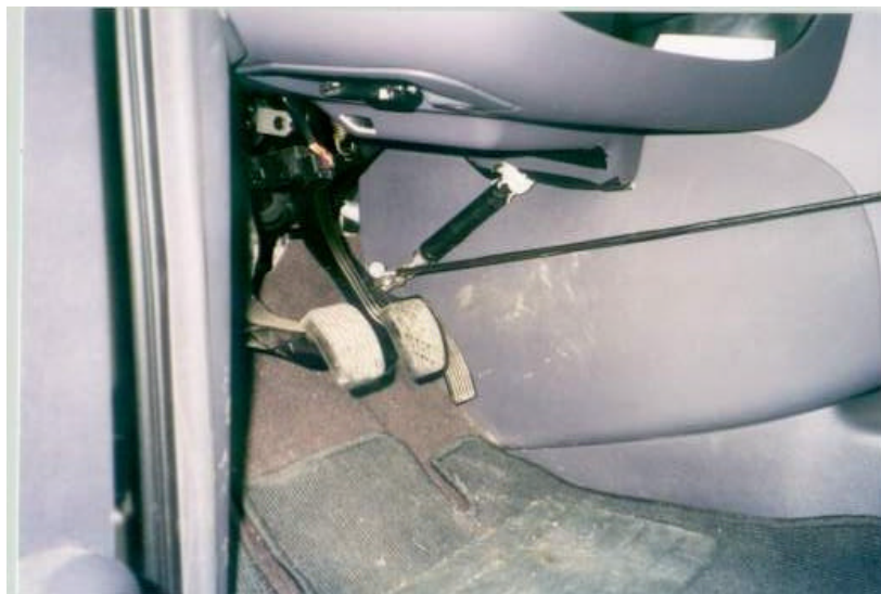
Abb. 10. Mechanische Gaspedalfixierung bei Mercedes A1
