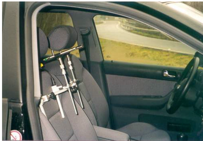
Abb. 12. Mikrofonaufbau zur Aufnahme in Stereotechnik. (ohne Trennscheibe)
