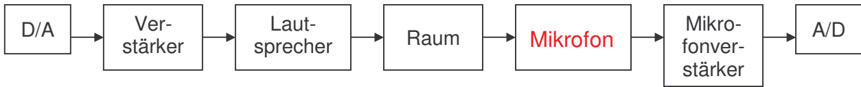
Abb. 2.2: Gesamtübertragungskette zur Impulsantwortmessung
