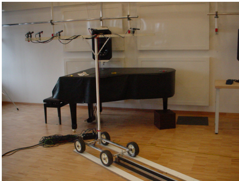
Abb. A.7: Messschlitten 2 mit fahrbarem Array
