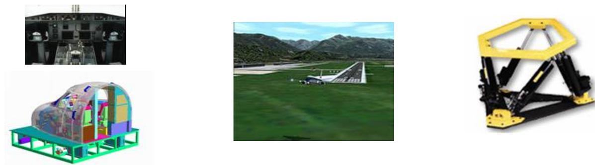
**Abbildung 2:** Flugsimulator (Level D) – und seine Bestandteile: Cockpit, Audio System, Vision System, Motion Base
