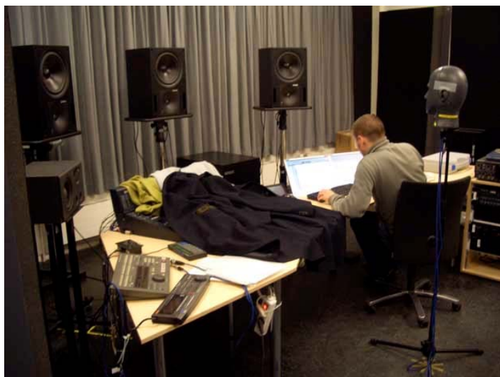
Abb. 9.1: Re-Recording der vier 5.1 Surround-MicArray Signale im Produktionsstudio des IEM mittels Neumann KU81i-Kunstkopf (Anm.: Das Yamaha DM 2000 Mischpult wurde mit Kleidung behelfsmäßig abgedeckt, um Reflexionen an seiner schallharten Oberfläche – und die dabei ev.
