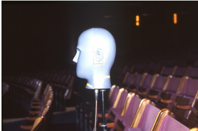
Abb. 10.3: Kunstkopf Neumann KU81i in der 6. Reihe, Mitte des Großen Festspielhauses Salzburg
