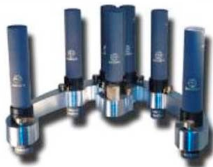
Abb. 5.11: TRINNOV-Surround Mikrofon Array (schematische Anordnung; bauliche Ausführung)
