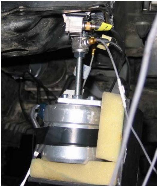
Bild 13: Befestigung eines der beiden Mini-Shaker an der Fahrzeugkarosserie und Beschleunigungsaufnehmer im Bereich der Krafteinleitungsstellen.
