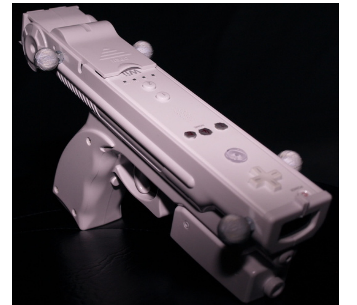
Zeigergerät für Lokalisationsversuche M. Frank, Foto: F. Zotter
